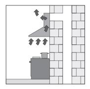
В этом режиме на вытяжку должны быть установлены угольные одноразовые запахоулавливающие фильтры.
