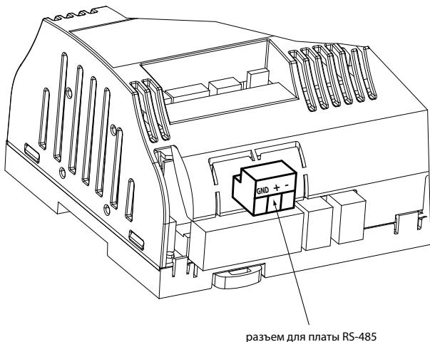
Рис. 5.d (детализация электронной платы, электрическая секция увлажнителя)
