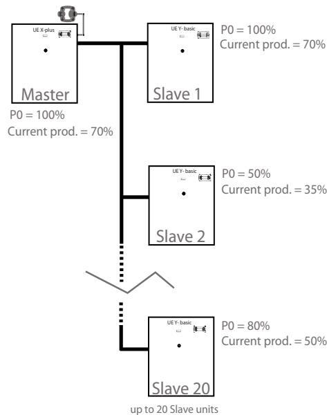
Схема соединения ведущего UER\*X\* и ведомых UER\*Y\* с помощью экранированных проводов
