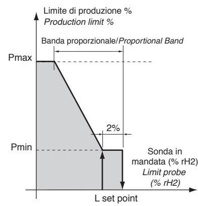
Рис. 14.c Управление с датчиком-ограничителем
