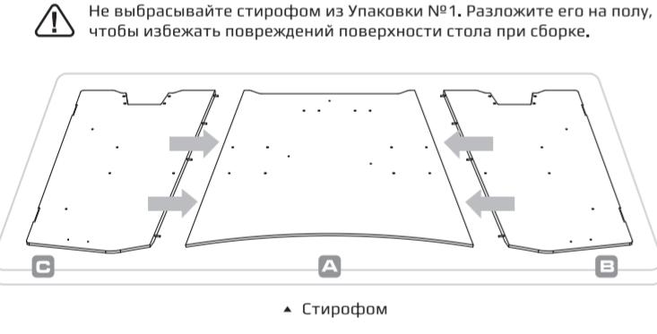
Не выбрасывайте стиропор из Упаковки №1. Разложите его на полу, чтобы избежать повреждений поверхности стола при сборке.
