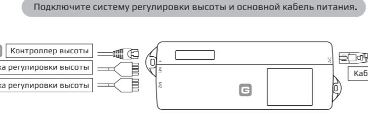
Подключите систему регулировки высоты и основной кабель питания.
