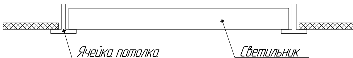
Рисунок 2 - Схема установки светильника
