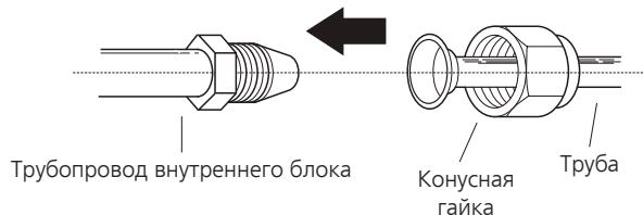
2. Затяните конусную гайку вручную до упора.
