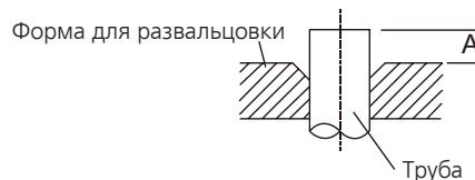
6. Установите инструмент для разバルцовки на форму.
