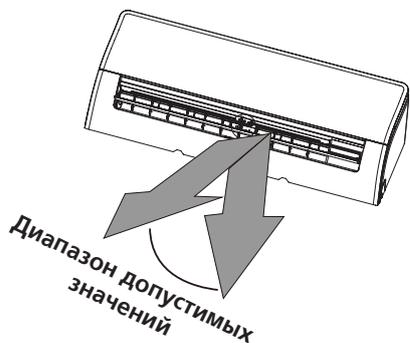
**ПРИМЕЧАНИЕ:** Не перемещайте жалюзи вручную. Это может сделать их автоматическое перемещение несинхронным. Если это произойдет, выключите кондиционер и извлеките вилку кабеля питания из розетки на несколько секунд. При последующем включении питания нормальное функционирование жалюзи будет восстановлено.
