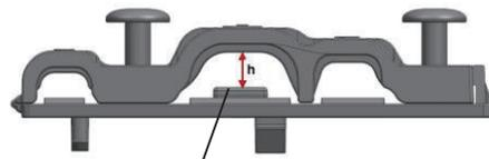
Если кабель не закреплен достаточно прочно, используйте фиксатор, чтобы поднять провод и зажать его плотно.
