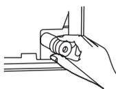
Для предотвращения нежелательных утечек закройте неиспользуемое дренажное отверстие прилагаемой резиновой пробкой.
