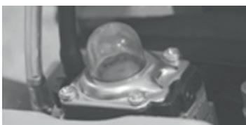
Перед запуском холодного двигателя 2-3 раза нажмите на праймер для обогащения смеси. При этом сквозь колпачок должно просматриваться подкачивающее топливо. Если топливо не заполнило колпачок, надавите на кнопку насоса еще несколько раз.
