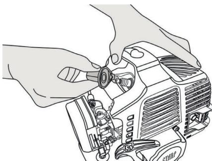
8.4.2 Снимите колпачок свечи зажигания (4) и удалите любую грязь вокруг основания свечи.
