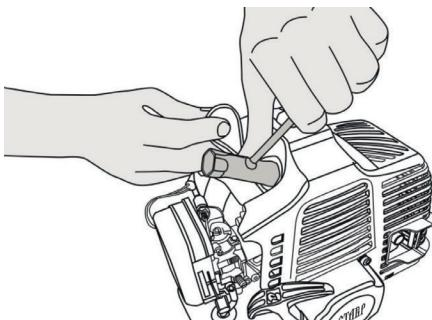
8.4.3 При помощи свечного ключа против часовой стрелки выкрутите свечу зажигания.
