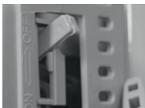
Перед запуском двигателя рекомендуется закрывать дроссельную заслонку (5) для уменьшения количества поступающего воздуха в карбюратор, а при прогреве двигателя постепенно открывать для снижения расхода топлива.
