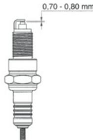
Зазор между электродами должен составлять 0,70-0,080 мм( 0,028-0,031 дюйма). При необходимости отрегулируйте зазор.
