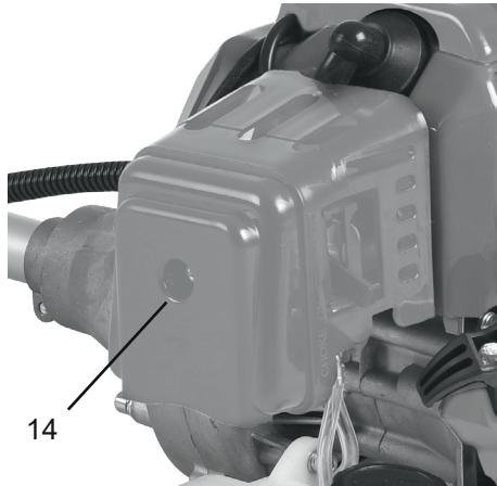
**8.5.2** Открутите гайку, фиксирующую крышку воздушного фильтра (6), и снимите крышку.
