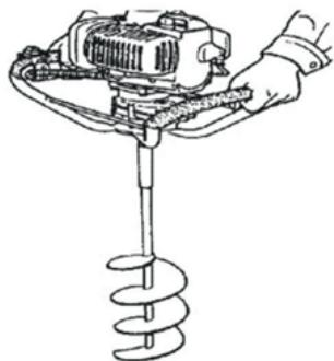
7.3.4 Займите устойчивое положение и начинайте работу. Крепко удерживая обе рукоятки, плавно выжмите рычаг газа (12). В процессе работы удерживайте мотобур строго в вертикальном положении. Не следует сильно давить на него.
