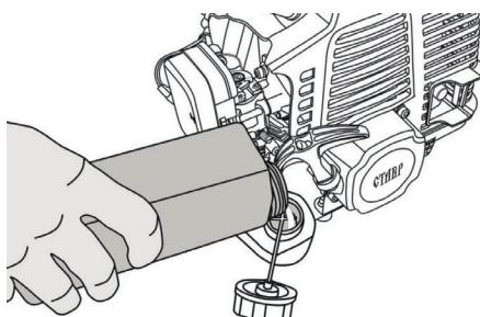
6.3.4 Залейте необходимый объем топливной смеси в бак и плотно закрутите крышку. В случае разлитого топлива его следует немедленно удалить сухой тканью.
