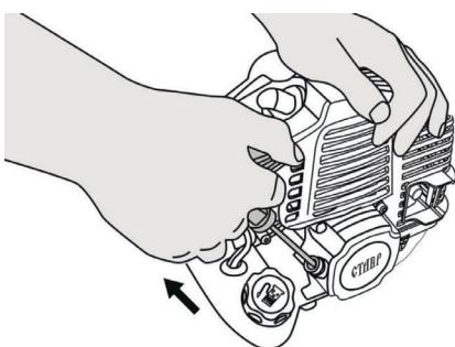
**ЗАПРЕЩЕНО** запускать двигатель без предварительного вытягивания шнура стартера до его «заципления». Сильные рывки ненатянутого шнура или вытягивание шнура до упора могут вызвать поломку механизма стартера и привести к повреждению двигателя.
