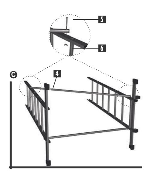
Регулировка уровня высоты достигается за счет перестановки секций лестницы.
