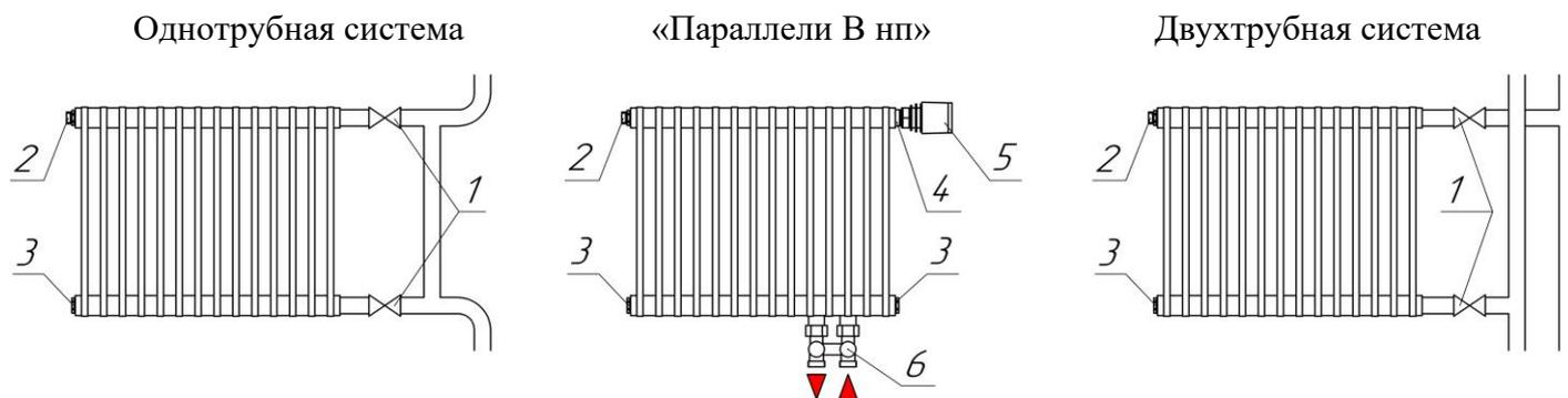
1. Вентиль. 2. Кран Маевского-воздухоотводчик. 3. Пробка глухая. 4. Клапан терморегулятора. 5. Термостатический элемент. 6. Запорно-присоединительный клапан нижнего подключения.
