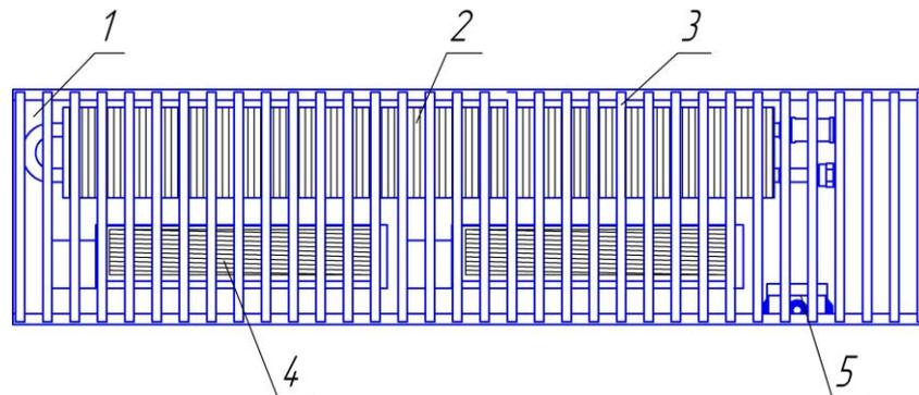
1. Короб. 2. Теплообменник. 3. Решетка. 4. Вентилятор. 5. Монтажная коробка или электронный модуль управления вентиляторами (ТСМ или МУВ).
