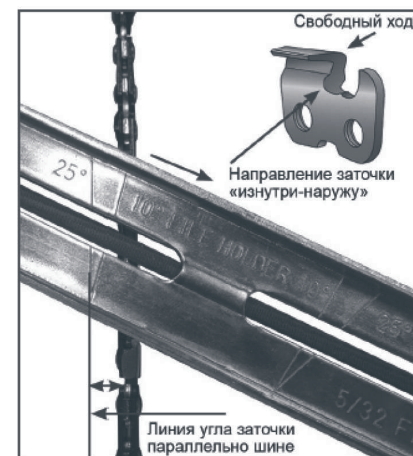
Рис. 26 Определение угла заточки
