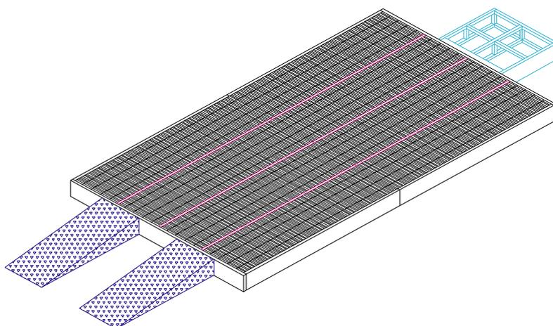
4) По окончании установки проверьте диагональ и горизонталь основания. Убедитесь, что диагональная погрешность не превышает 5 мм, а вертикальная погрешность не превышает 2 мм. Затем соедините стыковые части винтами.
