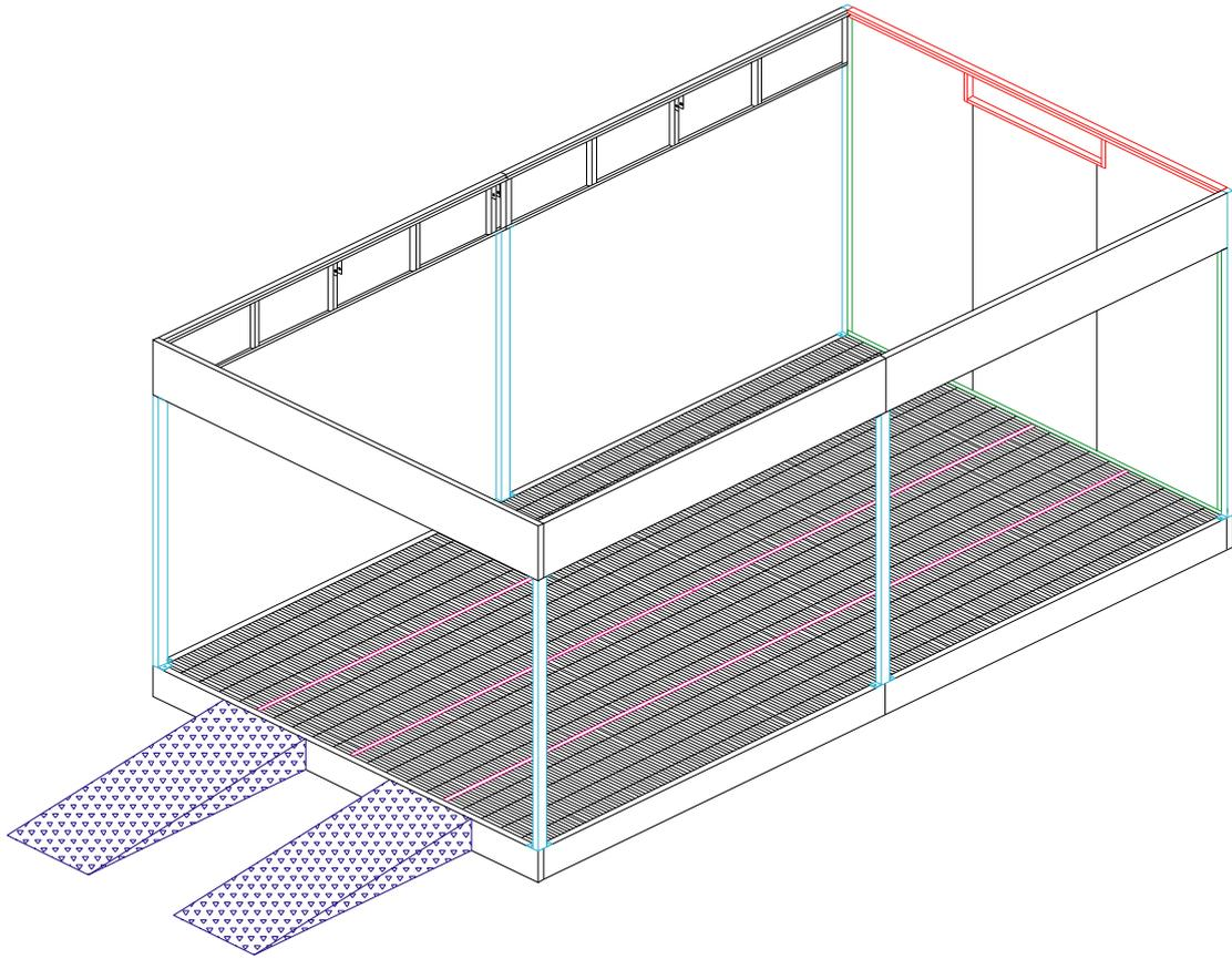
3) По окончании установки проверьте вертикальность стеновых панелей с помощью отвеса.
