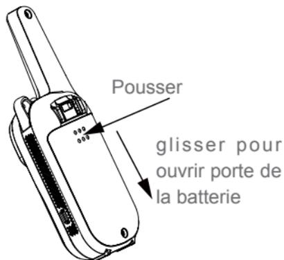
2. Installation des trois batterie AAA alcaline ou NIMH avec + et - polarité comme indiqué à l'intérieur.
