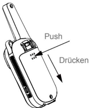
2. Installieren der drei AAA-Alkali- oder NiMH-Batterien mit + und Polarität wie innen gezeigt.
