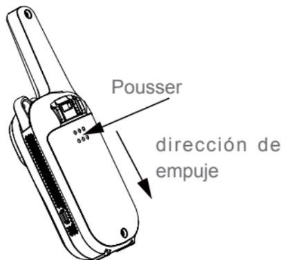
2. Instalación de la batería Tres Alkaline o NiMH AAA con + y - polaridad como se muestra dentro.
