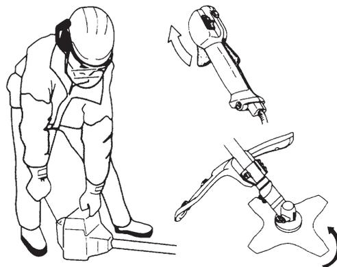
Запустите двигатель и проверьте работоспособность выключателя.
