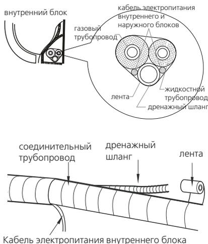
**Примечание:** Кабель электропитания и сигнальный провод (управления) не должны соприкасаться.
