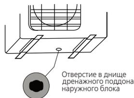
Отверстие в днище дренажного поддона наружного блока
