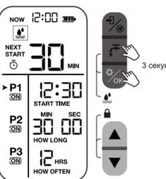
**Установка/Отмена:** Нажатие двух кнопок в течение трех секунд.
