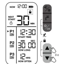
**Установка/Отмена:** Нажатие двух кнопок в течение трех секунд.
