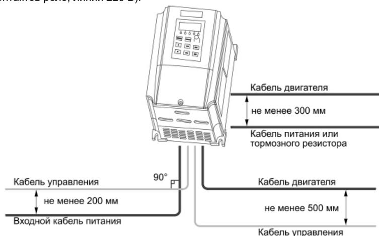
Для подключения цепи управления используйте экранированный витой кабель или экранированную витую пару; экран необходимо подключить к клемме заземления
