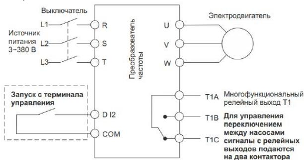
Схема коммутации преобразователя частоты в режиме поочередного управления двумя насосами для серии MC1
