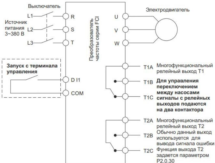
Схема коммутации ПЧ в режиме поочередного управления двумя насосами
