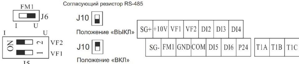
Стандартная конфигурация для преобразователей частоты серии MCI мощностью от 30 кВт
