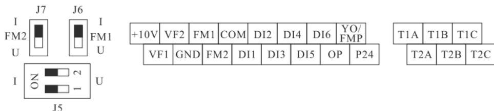
Стандартная конфигурация для преобразователей частоты серии FCI мощностью до 15 кВт
