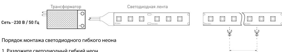
Порядок монтажа светодиодного гибкого неона
