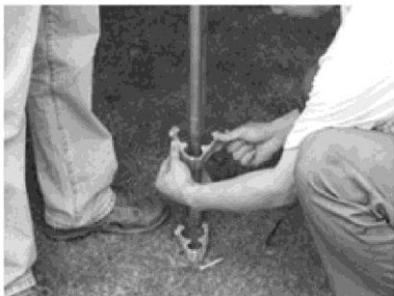
7. ПРИМЕЧАНИЕ: Прочно прикрепите нижнюю трубу к вертикальной части W-образной ножки, а не к удлинительной ножке – это очень важно. Затем зафиксируйте быстродействующий зажим с помощью болта.
