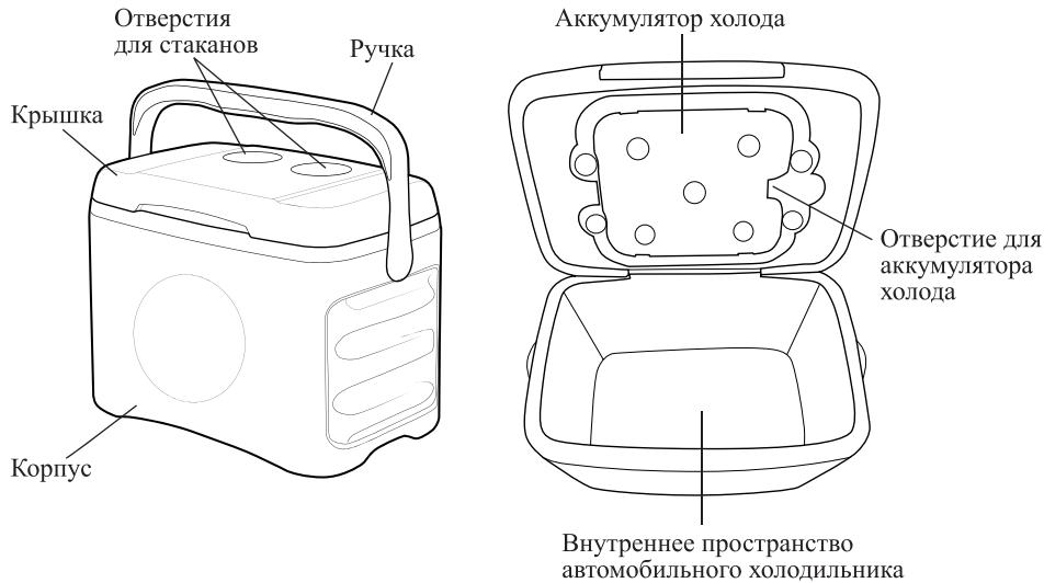
Автомобильный холодильник состоит из корпуса, несъемной крышки и ручки. В комплекте идет съемный солевой аккумулятор холода.
