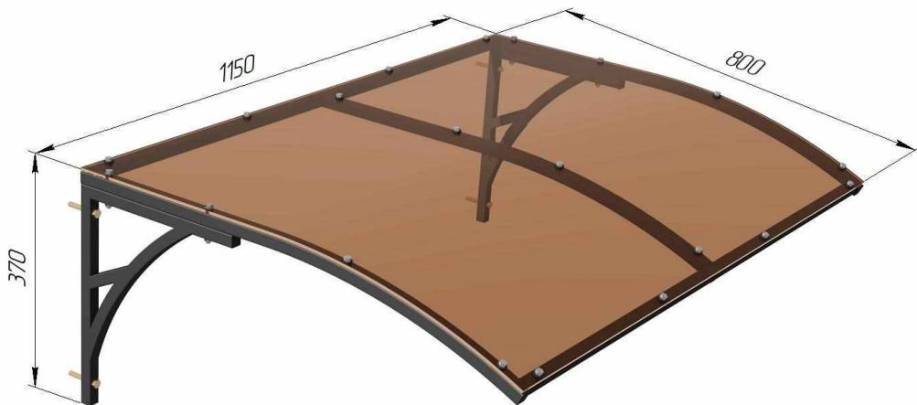
Рисунок 2. Габаритные размеры Козырька
