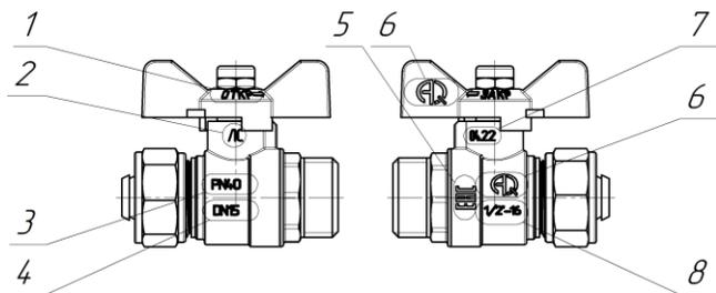
Рисунок 1 – Маркировка на изделии
