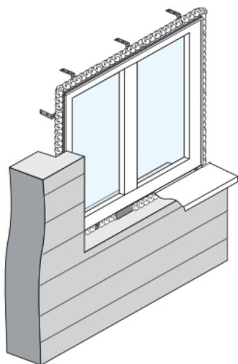
Отливы устанавливаются с наружной стороны после проведения всех монтажных и отделочных работ по установке окна ПВХ.
