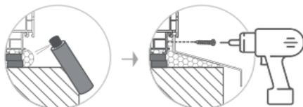
Правильно закрепленный отлив должен иметь наклон от окна.
