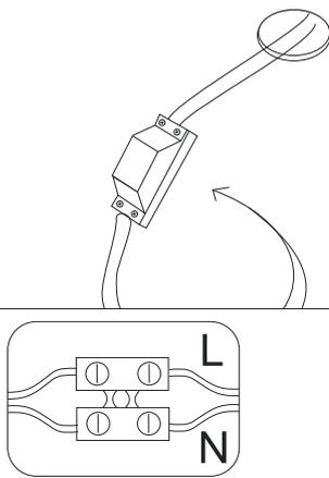
2. Подключите провода питания к клеммной колодке светильника, руководствуясь символами на колодке.
