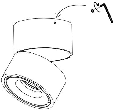
3. Закрепите светильник на основании, затянув два потайных винта при помощи Г-образного ключа.
