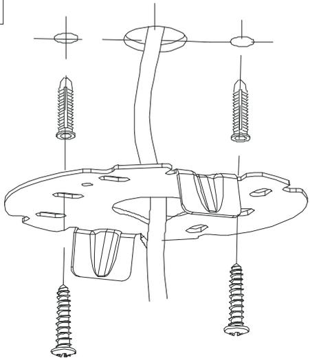
1. Подготовьте место для установки светильника, разметьте расположение крепежных отверстий, пользуясь основанием светильника в качестве шаблона, вставьте в отверстия дюбели. Закрепите основание светильника на стене при помощи двух шурупов.
