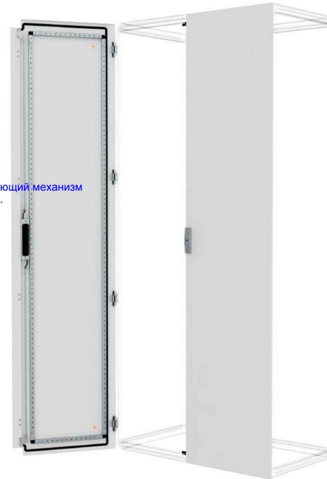
Двери глухие двухстворчатые предназначены для установки в рамы напольных линейных шкафов RS52 шириной 800-1200 мм включительно. Крепятся к вертикальным стойкам рамы при помощи петель. Установка фронтальная. Грузоподъемность двери не более 70 кг.
