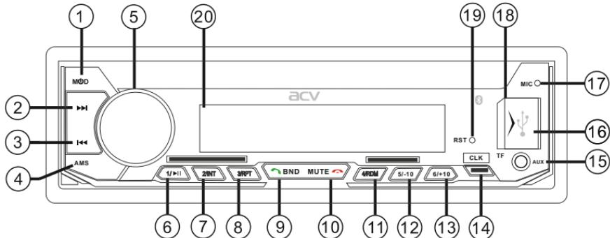
1. **MFD** - кнопка включения/выключения устройства, выбора режимов ресивера.
