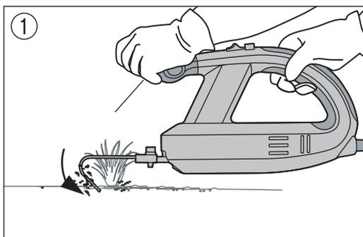
2. Запустите пропалочную машинку. Воткните металлическую насадку в землю (как показано на рисунке: по направлению стрелки)
