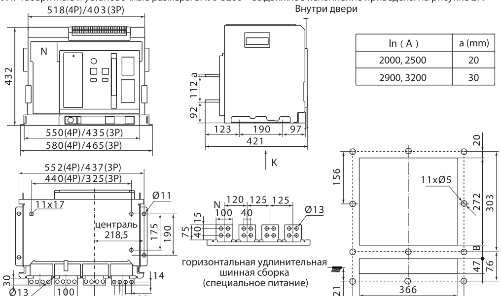
Рисунок 27. Габаритные и установочные размеры ВА90-3200 – выдвжное исполнение, мм
