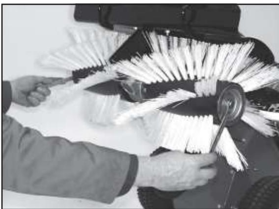
10) Теперь закрепите щетки контргайкой. (Придерживайте гайку на другом конце оси другим гаечным ключом)
