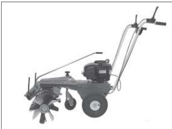
1) Регулярно проверяйте давление в шинах как на опорном, так и на ведущих колесах.
