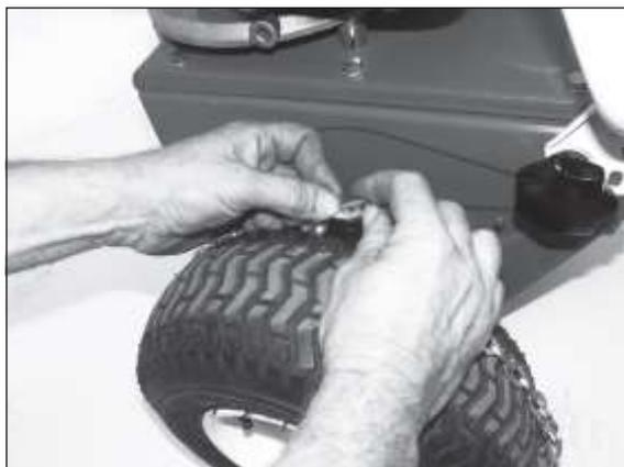
3) Натяните цепь на колесо и зацепите ее. Поднимите задний конец цепи и зацепите ее.
