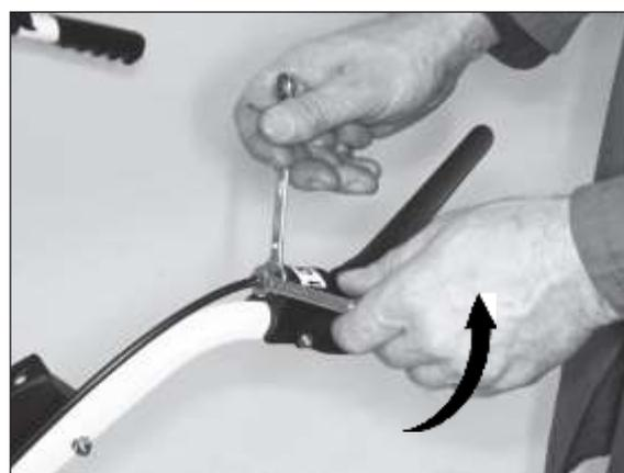
2) После этого поворачивается левый винт с 8-дюймовым размером на оборот в направлении стрелки.
