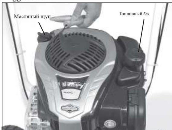
1) Топливные и масляные баки на двигателе V&S.
