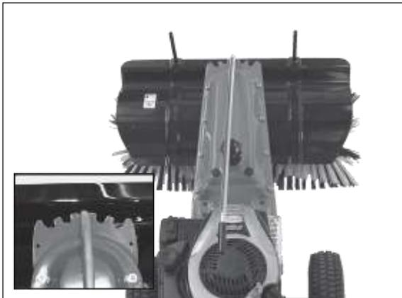
Существует пять различных положений, доступных для регулировки направления выброса.
