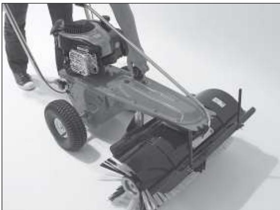
Нажим щетки можно регулировать плавно с помощью регулировки опорного колеса по высоте
