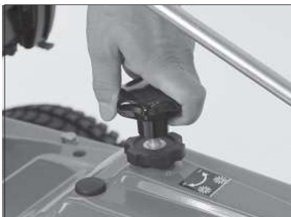
Следует опустить щетку настолько, чтобы она касалась земли. Затем прокрутить еще 3 оборота против часовой стрелки в направлении, отмеченном знаком (-).
