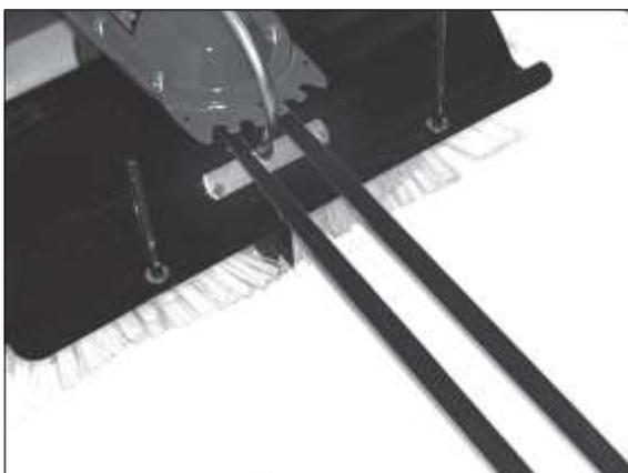
3) Положение фиксирующего ремня спереди.
