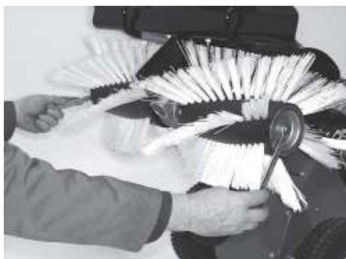
Затяните с помощью гаечного ключа. (Вам придется удерживать гайку на другом конце оси другим гаечным ключом).
