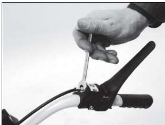
1) Ослабьте верхнюю гайку с помощью кольцевого гаечного ключа диаметром 10 мм (прибл. один поворот).
