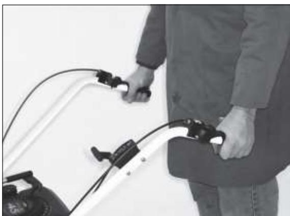
3) Если вы нажимаете на оба рычага, будут включены как привод щетки, так и привод колес.
