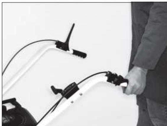
2) Включите привод колес, нажав на левый рычаг.
