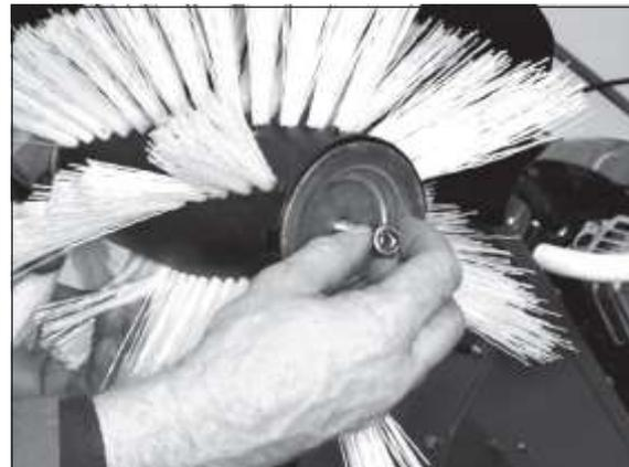
2) Снимите гайку и снимите щетку.
