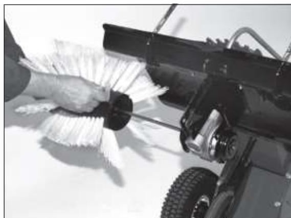
5) При установке новых щеток сначала установите щетку вместе с осью. Пожалуйста, ознакомьтесь с начальной инструкцией по сборке.
