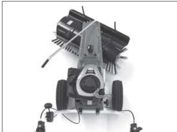
Приподнимите поворотный рычаг так, чтобы он вышел из переднего положения. Затем поверните щетку в нужном направлении и позвольте рычагу снова попасть в паз и надежно зацепиться. Здесь: направление выброса вправо.
