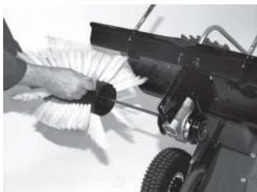
Протолкните щетку с осью через отверстие в редукторе щетки.
