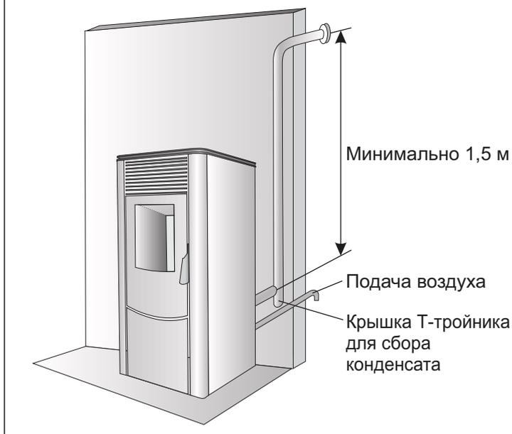
**Рис. 4.** Наружная установка дымохода, которая должна осуществляться в соответствии с правилами
