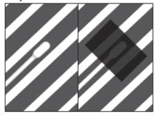
Проделайте прорезь под провод датчика и его головку в материале теплоизоляции, если не используете гофрированную трубу для вывода установочного провода датчика температуры.
