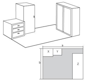
3. Начертите план помещения с указанием конфигурации площади обогрева и функциональных элементов пленочного теплого пола.
