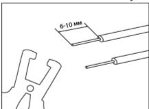
Вставьте зачищенный от изоляции конец установочного провода (или два конца провода, если необходимо) в зажим и с усилием зажмите его с помощью пассатижей или специального инструмента. Убедитесь, что конец провода надежно закреплен в зажиме.
