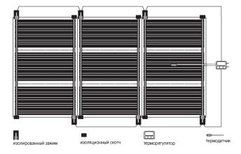
Укажите на плане расположение полос нагревательной пленки, места подключения установочных проводов к нагревательным пленкам, места прокладки установочных проводов от нагревательных пленок до терморегулятора.
