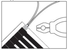
Изолируйте все места подключения установочных проводов с зажимами изоляционным скотчем. Для изоляции используйте два отрезка изоляционного скотча размером 50x70 мм каждый.
