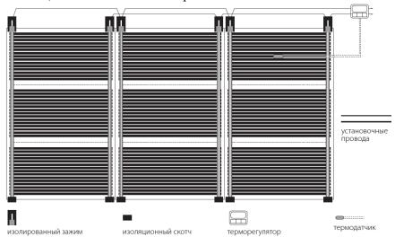
Общая схема подключения нагревательной пленки к терморегулятору в случае, когда нет возможности поместить установочные провода в глубокие канавки, кабель каналы, исключающие непосредственное механическое воздействие на них (непосредственно под напольным покрытием без дополнительной защиты от механических воздействий) (вид снизу).
