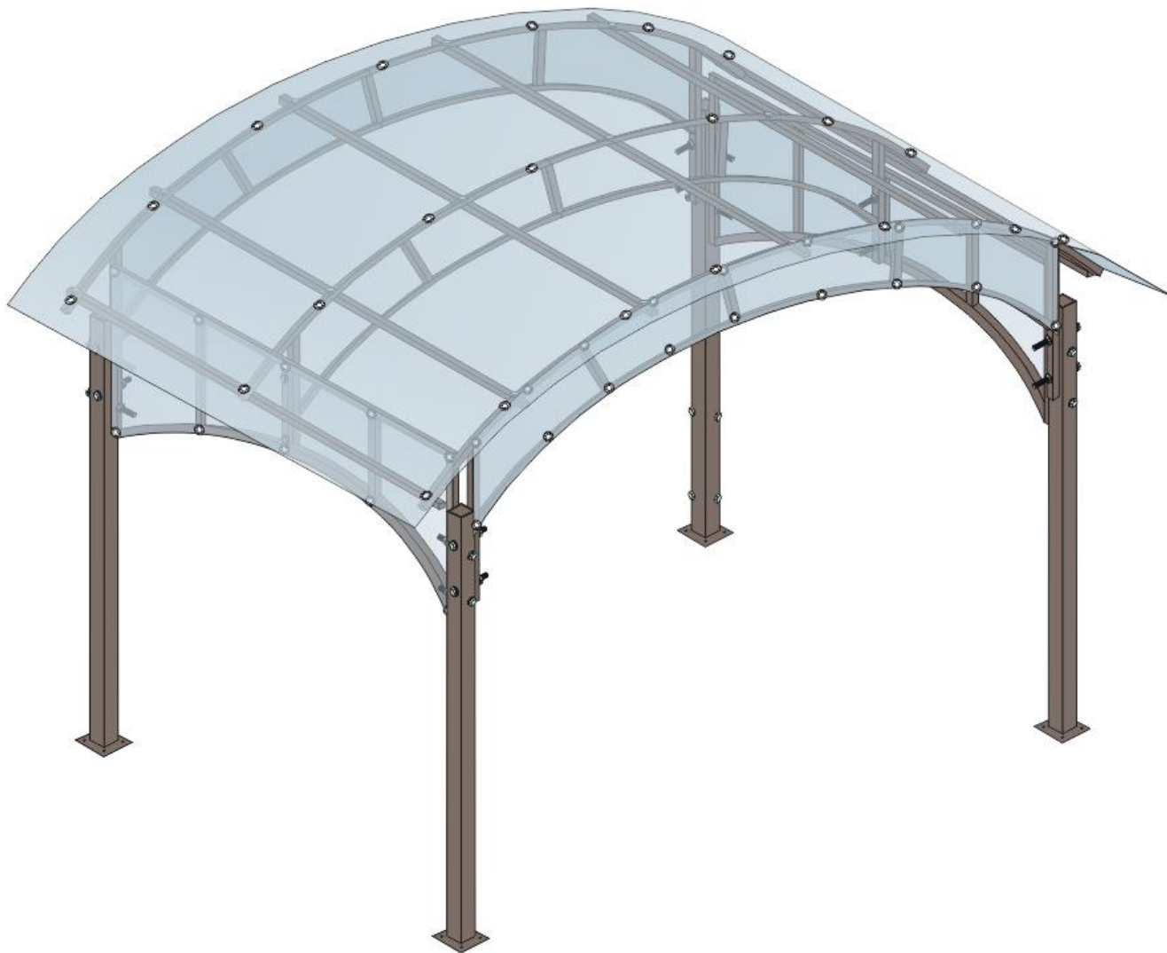
Рис.15 Покрытие крыши поликарбонатом
