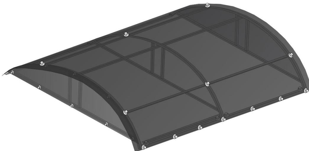
Рис. 11 Покрытие крыши поликарбонатом
