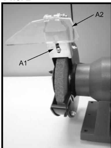
**Сборка/Регулировка – Предохранительный щиток (Рис. 2).** Закрепить предохранительный щиток (A2) с помощью поставляемых винта и шайбы и зафиксировать его в нужном положении, убедившись в том, что регулируемая рама находится на достаточном расстоянии от шлифовального круга.
