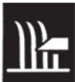
Поднимает или опускает режущую деку и тем самым регулирует высоту кошения травы. Этот рычаг имеет семь положений (показаны на этикетке как «1» – «7»), соответствующих высотам от 30 до 90 мм.
