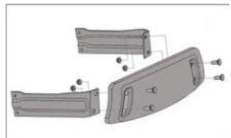
б. Прикрепите передний бампер к нижней части рамы 4-мя гайками М8 и 4-мя болтами М8 x 20. (Используйте ключ с 13 x 15 из комплекта вспомогательных инструментов.)
