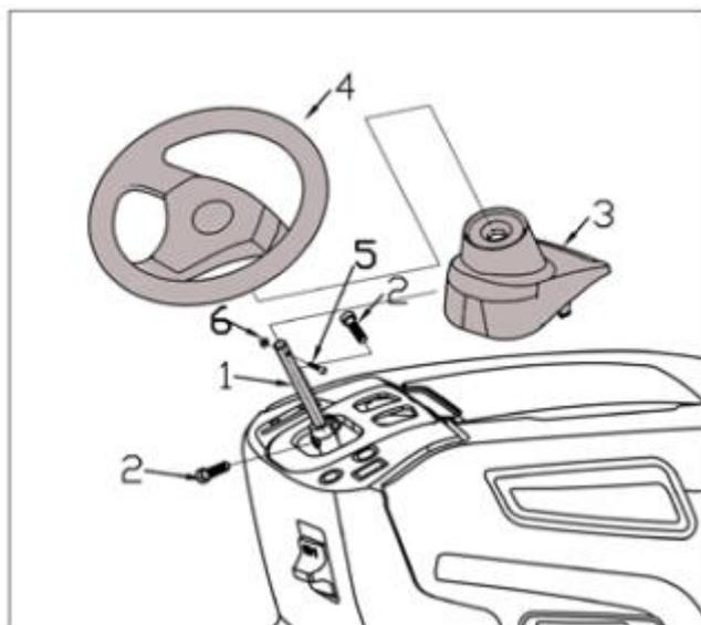
с. Установите рулевое колесо (4) на вал рулевого управления, вставьте винт (5) и затяните его гайкой (6).
