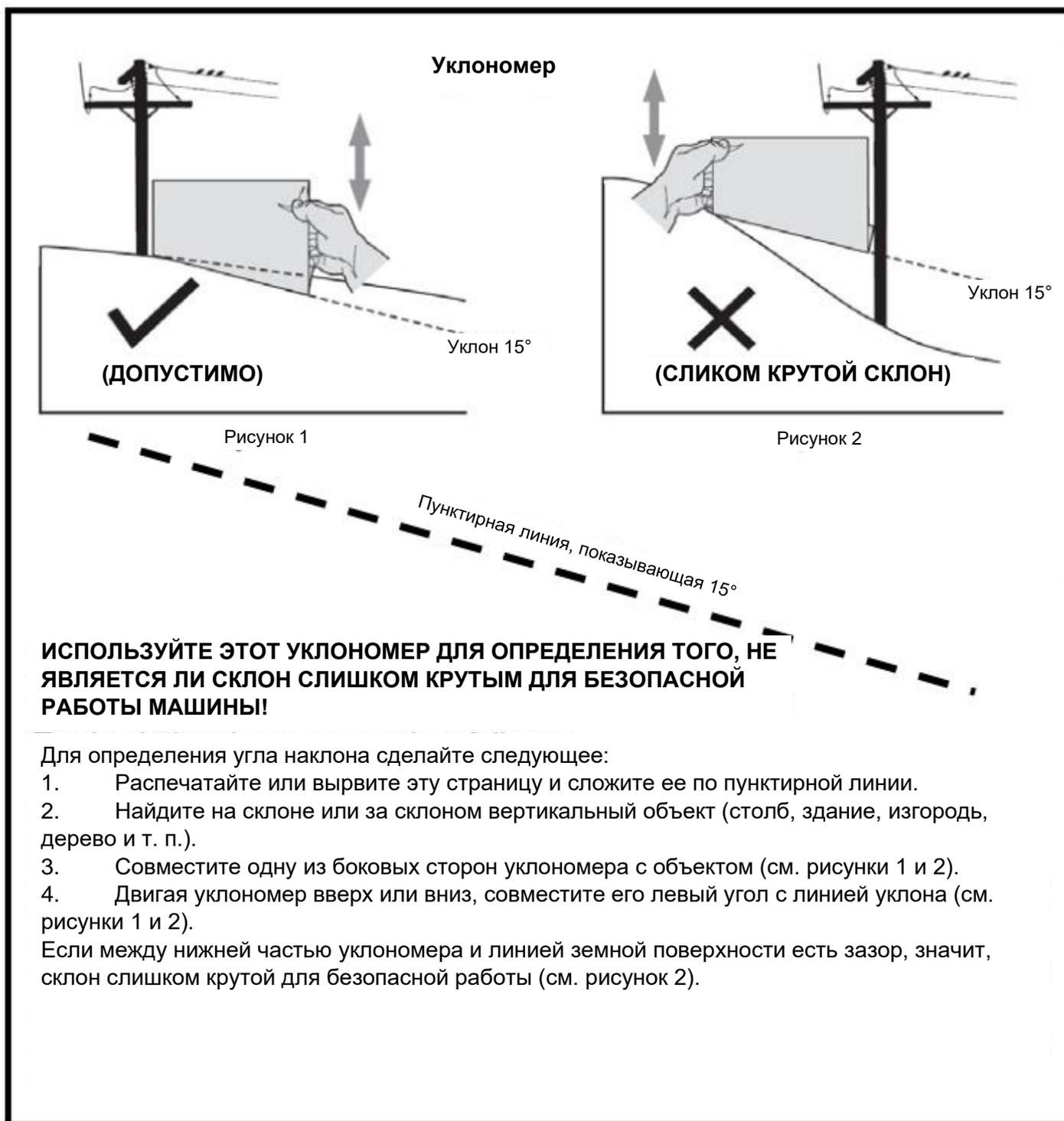
**ПРЕДУПРЕЖДЕНИЕ!** Использование машины на склонах сопряжено с риском опрокидывания, что может привести к травме или смерти. Не используйте машину на склонах с углами наклона более 15° и будьте чрезвычайно осторожно при работе на любом склоне.
