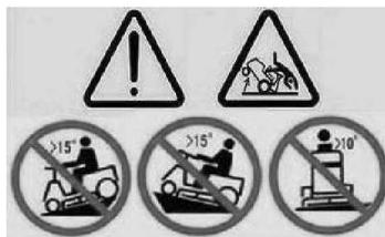
склона. При изменении направления движения на склоне следите за тем, чтобы колеса не наталкивались ни на какие препятствия (камни, ветки, корни и т. п.), способные привести к боковому скольжению машины, опрокидыванию или потере управления.
