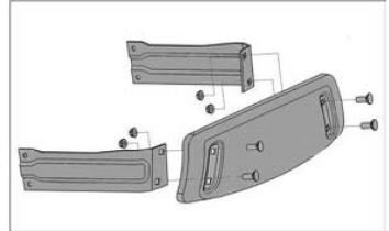
б. Прикрепите передний бампер к нижней части рамы 4-мя гайками и 4-мя болтами. (Используйте ключ 13x15 из комплекта вспомогательных инструментов.)
