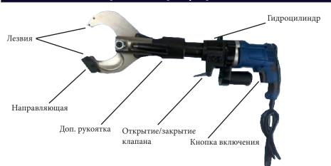
Электро-гидравлический кабелерез MLC-65 состоят из гидроцилиндра, лезвий и опорной ножки. Ножницы подключаются к сети 220В. Рабочая жидкость, нагнетаемая помпой, поступает в гидроцилиндр, поршень под давлением начинает перемещаться, приводя в действие рычажно-осевой механизм. На нижнем лезвии установлены специальные направляющие, для обеспечения постоянного зазора между лезвиями во время резки кабеля.
