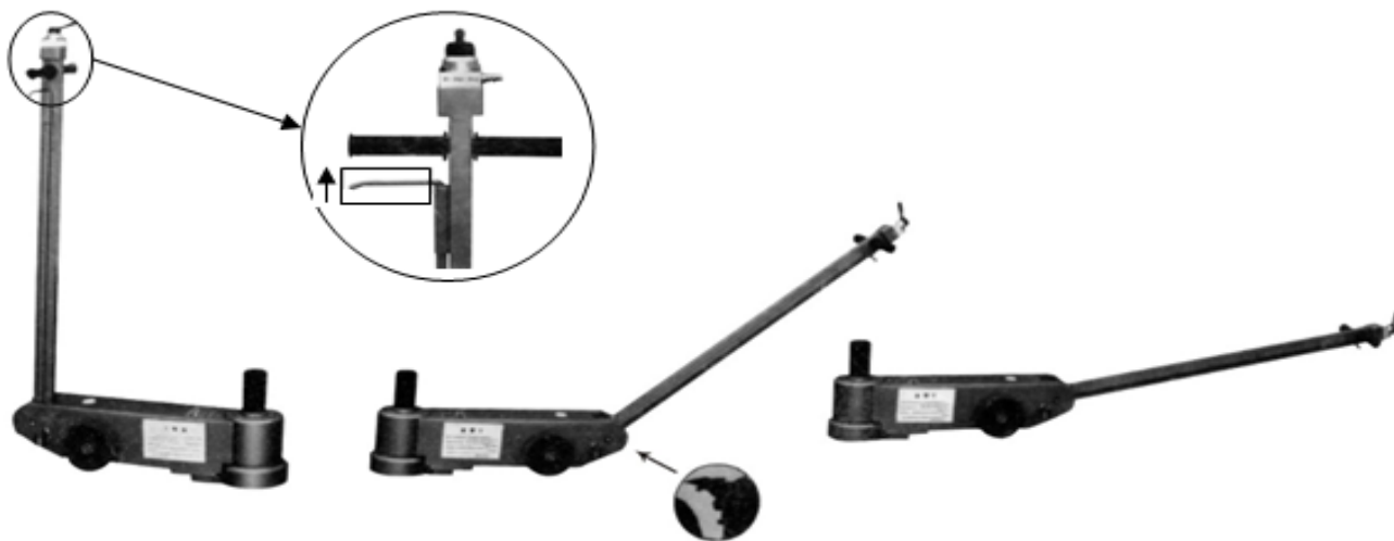
Рисунок 1. Изменение положения рукоятки управления.
