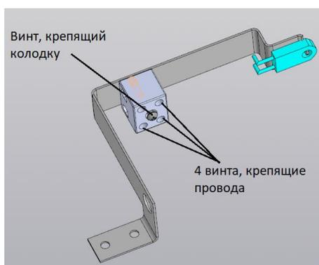
4. Отсоединить термopедохранитель и заменить.
