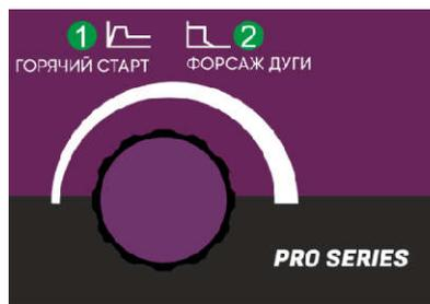
1. Регулировка параметра «Горячий старт» от 0 до 10 (условные обозначения)
