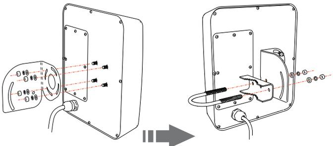
Установите наклонно-поворотный кронштейн антенны как показано на рисунке
