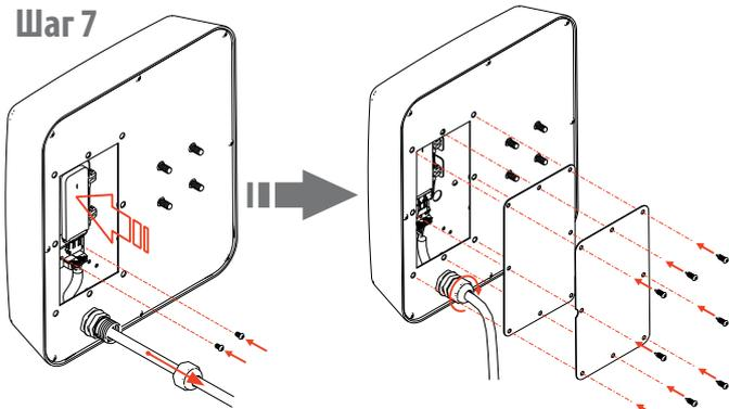
Установите 3G/4G USB-модем внутрь отсека антенны, вытяните лишний кабель, затяните колпачок гермоввода и установите крышку.
