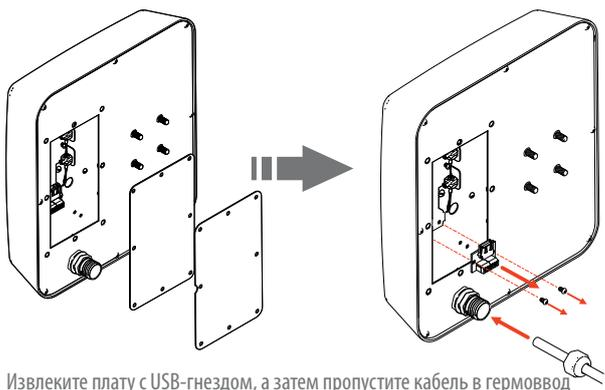
Извлеките плату с USB-гнездом, а затем пропустите кабель в гермоввод
