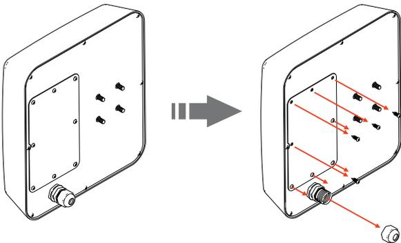
Снимите крышку отсека модема и колпачок гермоввода
