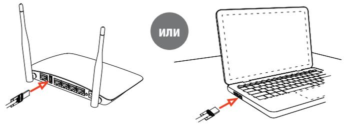
Подключите штекер к USB-порту роутера, ноутбука или ноутбука. Для удобства настройки антенны, рекомендуем окрывать интерфейс управления модемом, отображающий уровень сигнала.
