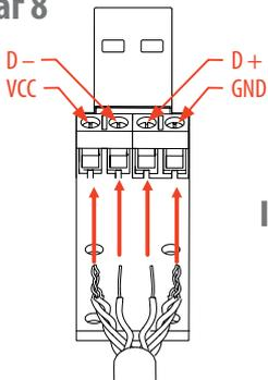
При подключении шины данных и шины питания цвета пар проводов должны совпадать с подключением USB-гнезда на шагах 3 и 4
