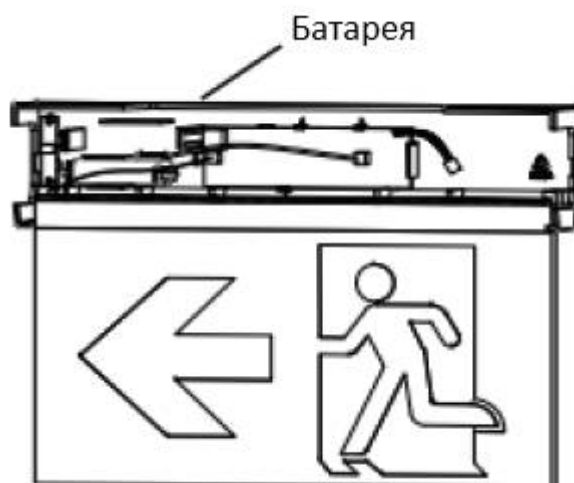
Рисунок 3 - Подключение батареи к плате
