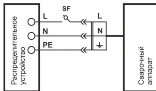
При подключении сварочного аппарата к электрической сети переменного тока напряжением 230В и частотой 50Гц необходимо обеспечить защиту розетки для подключения автоматическим выключателем или плавкой вставкой с током срабатывания соответствующим максимальному току потребляемому аппаратом.
