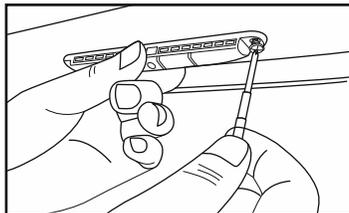
Закрепите индикатор двумя саморезами.
