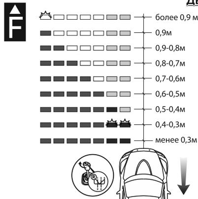
После включения заднего хода система активируется, повторно проводит самодиагностику (см. стр. 7) и работает все время, пока включен задний ход.
