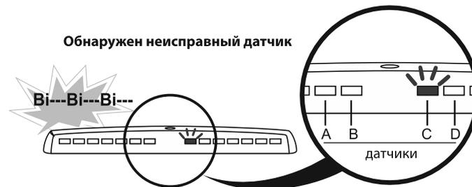
Пример: неисправен датчик C
