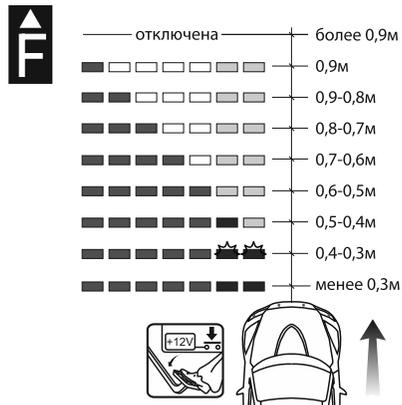
Система включается после включения зажигания (ACC), проводит самодиагностику (см. стр. 7) и работает в течении 8 или 20 сек\*. Далее система будет активироваться при нажатии на педаль тормоза. Система работает все время, пока педаль тормоза нажата и продолжает работать 8 или 20 сек\* после того, как педаль отпущена.
