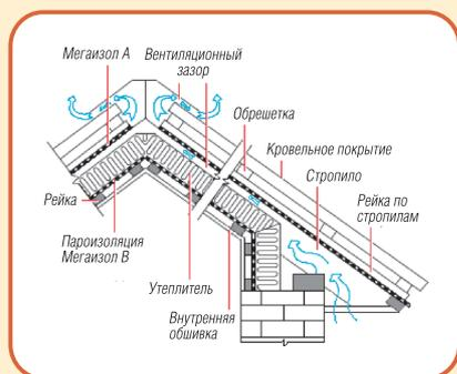
**В УТЕПЛЕННЫХ КРОВЛЯХ** и стенах пароизоляция «Мегаизол В» укладывается с внутренней стороны утеплителя на элементы несущего каркаса (стойки, балки, стропила) или по черновой обшивке при помощи оцинкованных гвоздей или строительного степлера. Укладка пароизоляции производится **с плотным прилеганием гладкой стороной к утеплителю**.
