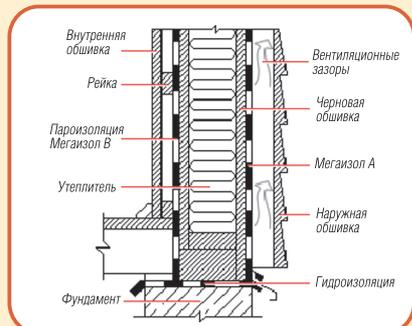
**В КАРКАСНЫХ СТЕНАХ** пароизоляция «Мегаизол В» укладывается непосредственно на внутренней поверхности стены шероховатой стороной внутрь помещения. Для монтажа пароизоляции на кирпичных или блочных стенах применяется соединительная лента «Мегаизол SL». Затем материал закрепляется контррейками или оцинкованными профилями, на которые устанавливается внутренняя обшивка (вагонка, декоративные панели, гипсокартон и т.д.).
