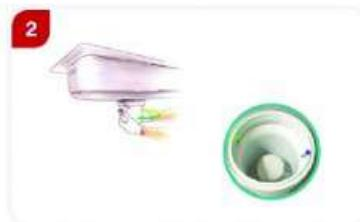
Переливное отверстие на раковине должно совпасть с переливным отверстием на корпусе сифона.
