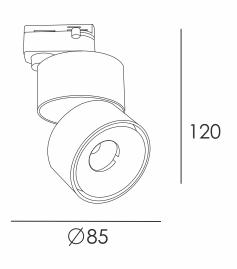
D85xH120mm Размеры Материал алюминий Рабочее напряжение 21-53 Мощность 12W Рабочая температура -25...45°C Влажность 280 Цвет черный/белый 3000K/4000K Цвет свечения Световой поток 905/1100<sub>A</sub>M
