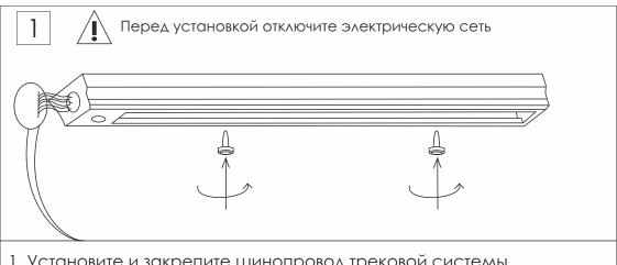
1. Установите и закрепите шинопровод трековой системы (приобретается отдельно) на потолке. Подключите шинопровод к сети питания 220В.
