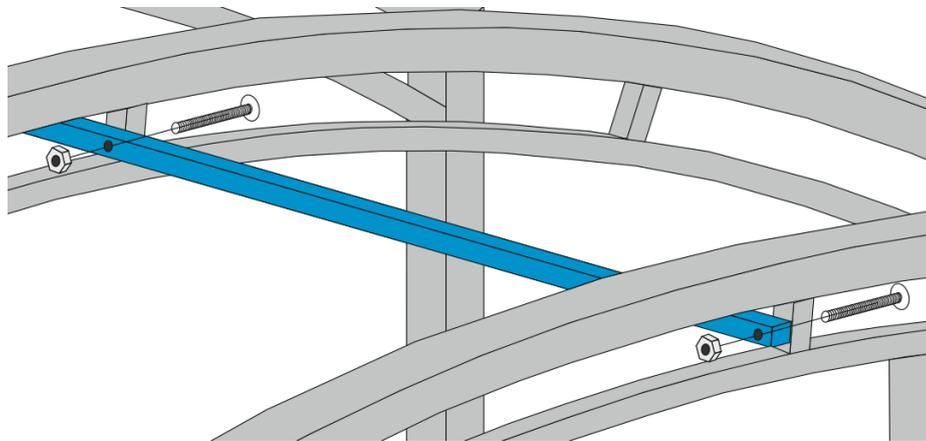
Рис № 13. Установка стяжек на крыше
