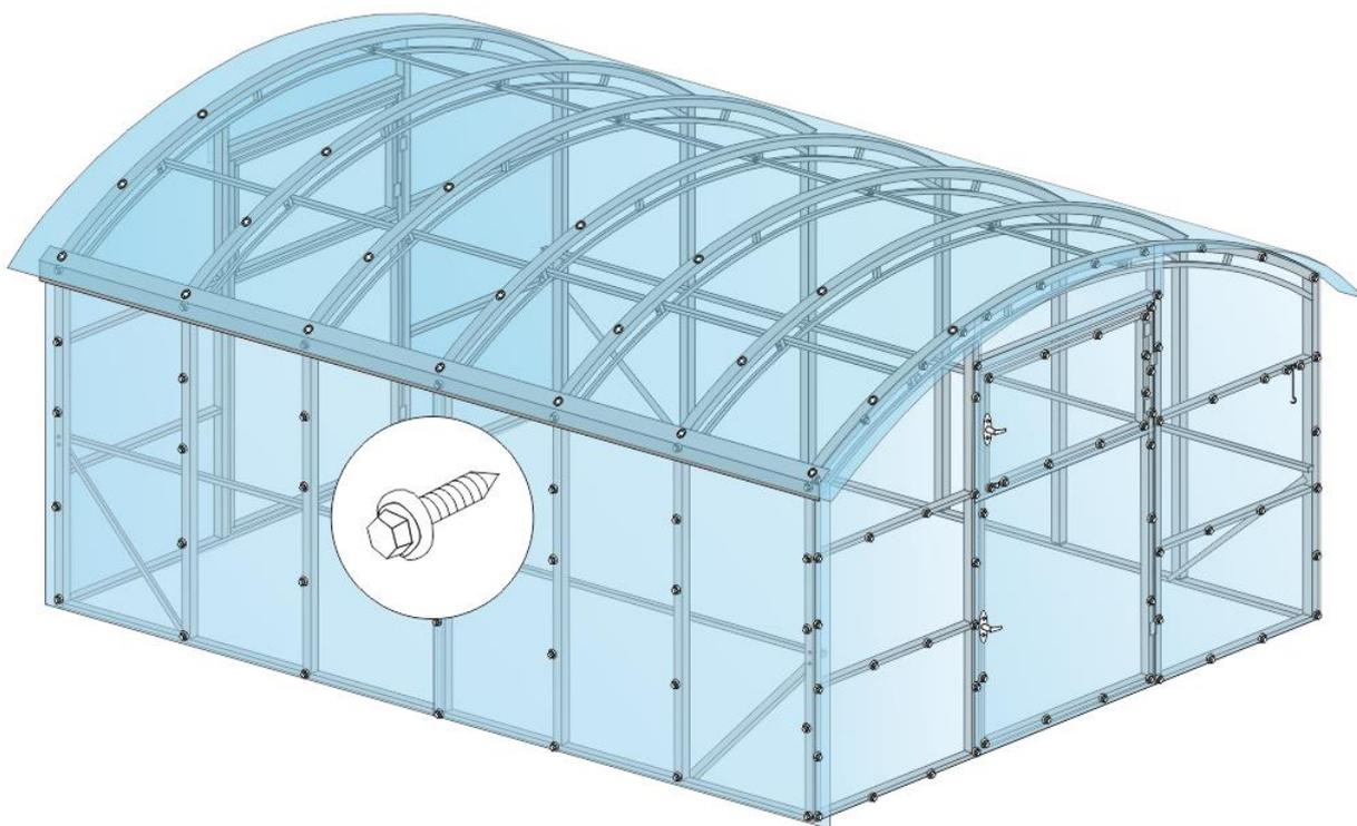
Рис № 18 Покрытие поликарбонатом крыши теплицы
