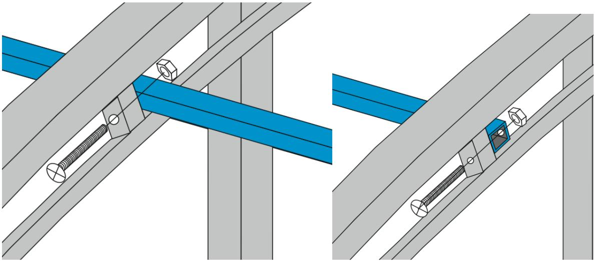
Рис № 12. Установка стяжек на крыше
