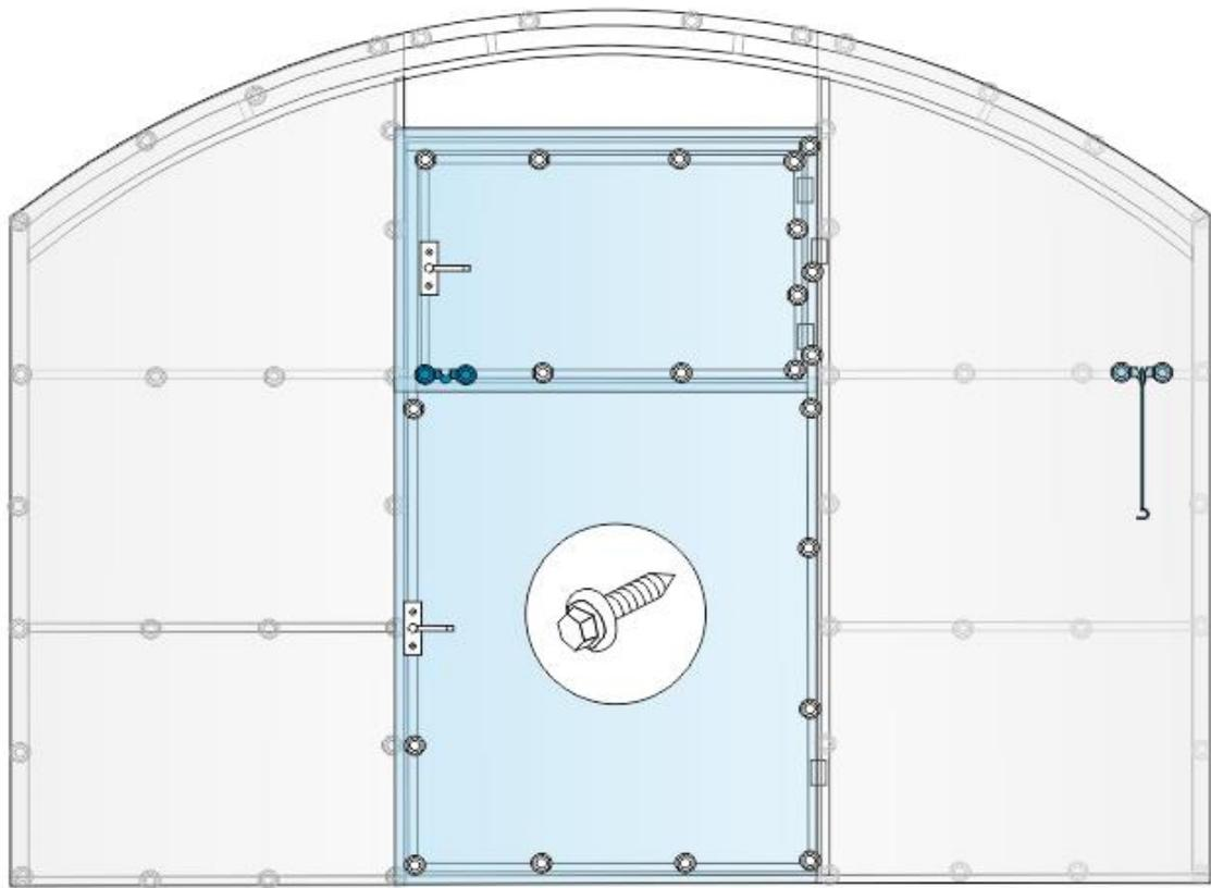
Рис № 3. Точки крепления саморезов на торцах теплицы.
