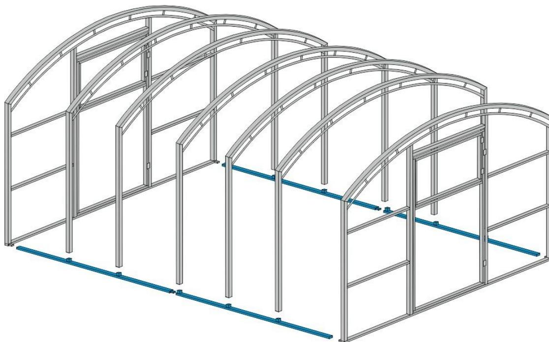
Рис № 10. Установка торцов и дуг
