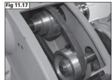
Вес двигателя должен обеспечить достаточное натяжение для приводного ремня. После того, как двигатель был опущен вниз, затяните натяжной рычаг. Если ремень проскальзывает во время работы, может потребоваться немного увеличить натяжение.
